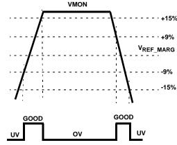
FIGURE 3. UNDERVOLTAGE-OVERVOLTAGE WINDOW
